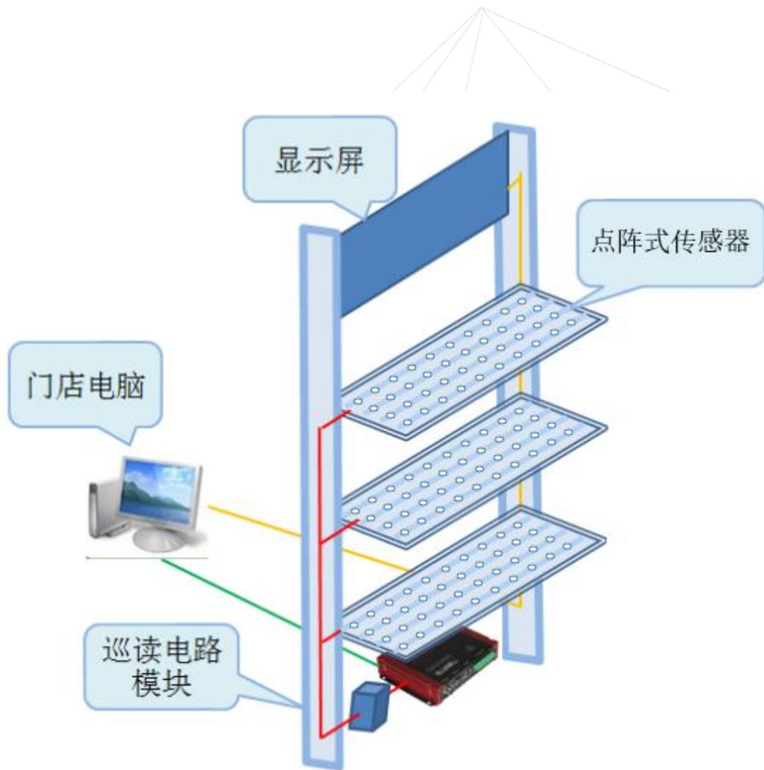
技术原理：利用红外的检测方向遇到障碍物时，红外信号反射回来识别周围环境的变化特点，来识别货架上的商品有没有被拿走或者放下。
